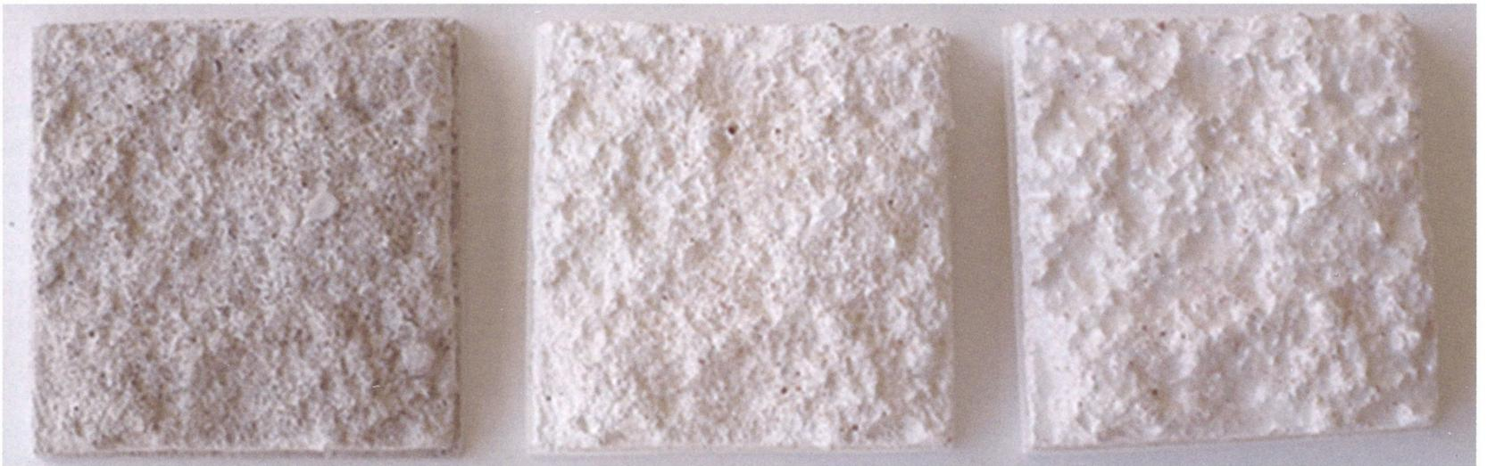
Na figura 7, apresentam-se os resultados visuais da experimentação do efeito da “contaminação” de superfícies exteriores de contentores em faiança com as cinco terras utilizadas neste estudo sobre a textura e a cor dos produtos posteriormente vidrados cozidos.
