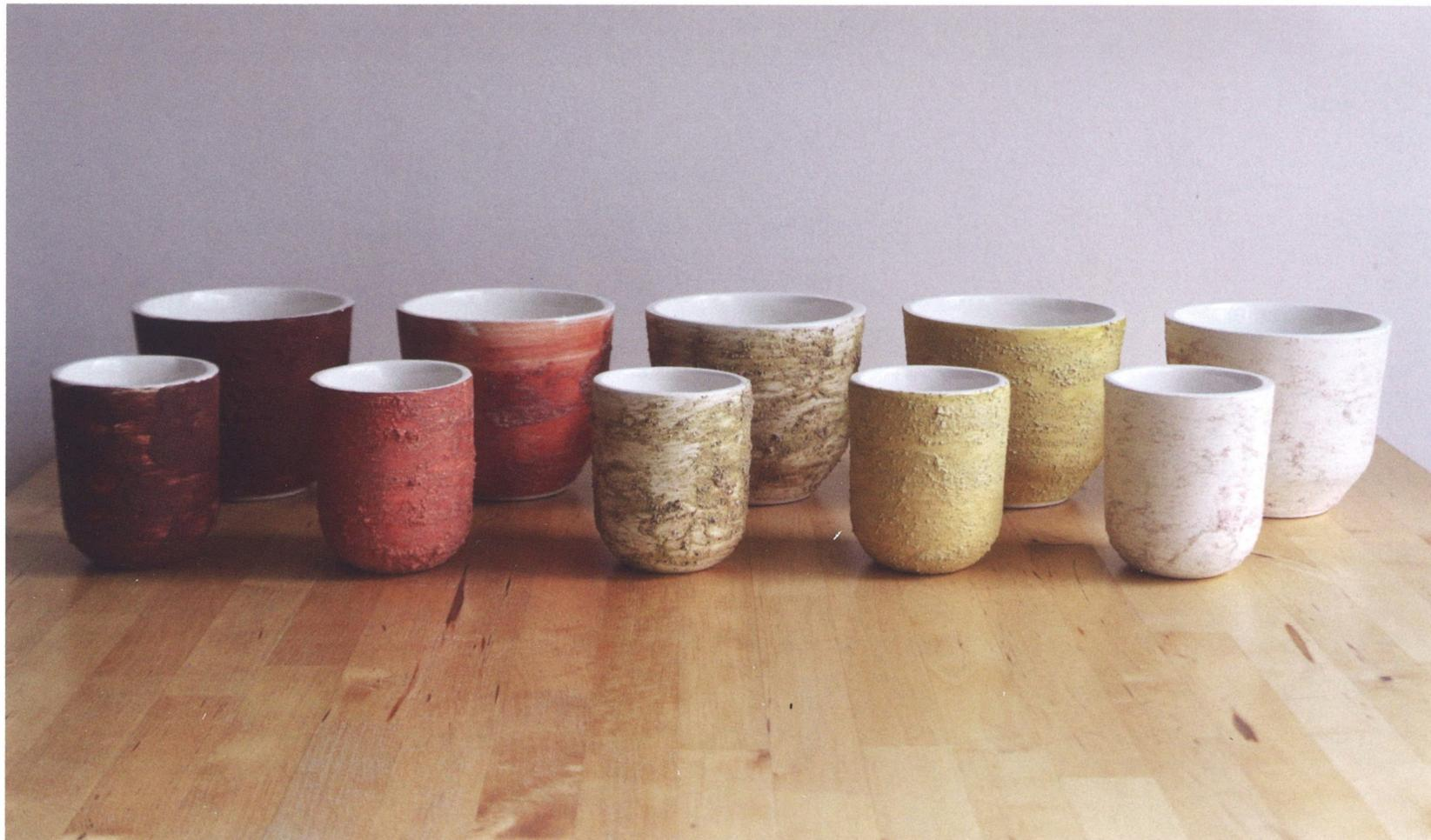
das para revestir a pincel a superfície de cinco taças previamente conformadas e chacoalhadas em faiança branca. Os resultados obtidos após cozedura são os que se apresentam na figura 8.
