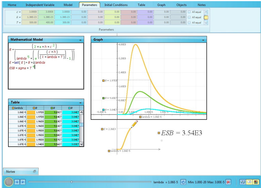
Figura 1: Modelo Modellus onde no Modelo Matemático se mostra a função densidade de potência da radiação B(\lambda) e a integração numérica em \lambda que conduz à lei de Stefan-Boltzmann relativa à potência irradiada por unidade de área E . Mostram-se também o Gráfico com as três curvas para três temperaturas diferentes, T = 500 \text{ K} (laranja), T = 400 \text{ K} (verde) e T = 300 \text{ K} (azul), a Tabela e a Animação com a Caneta que desenha o gráfico de E em função de \lambda e a Variável \sigma T^4 que mostra o limite de Stefan-Boltzmann para T = 500 \text{ K} .
