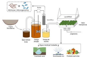
Figura 1. Configuração do sistema de tratamento por vermifiltração e hidroponia.
