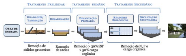
Figura 1. Esquema do tratamento da fase líquida da ETAR de Olhalvas (Duarte, 2023).
